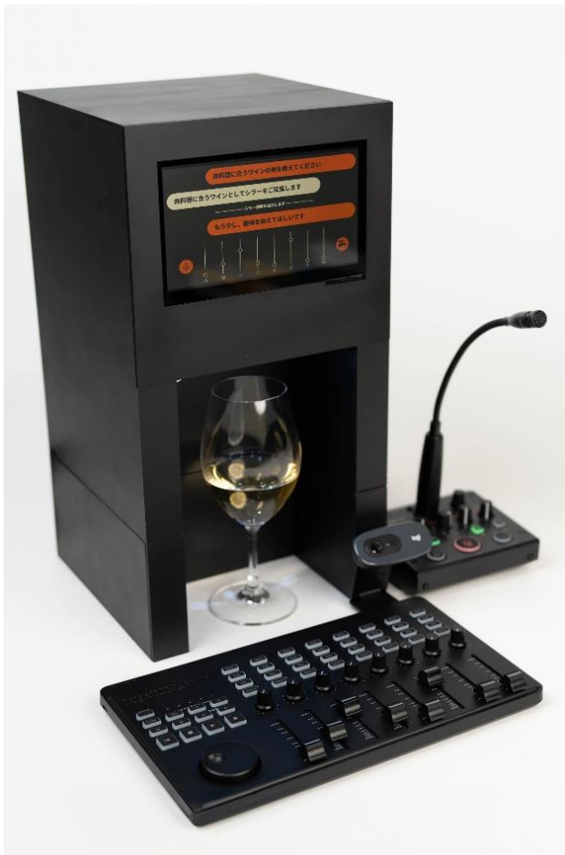
図 2 TTTV3 のシステム。タッチパネル、ウェブカメラ、マイク、操作コントローラを備える。
